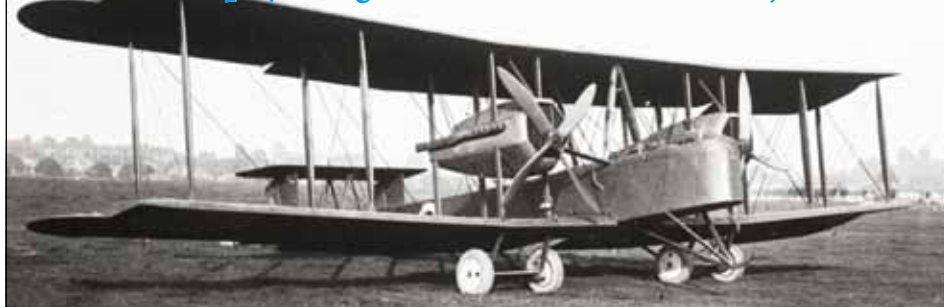
Vickers Vimy IV med to 12-cylindrede 360 hk Rolls Royce motorer i originalversionen som bombefly
